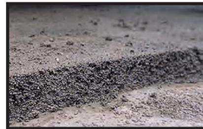
Les bétons légers sont obtenus en jouant sur la composition (bétons caverneux) ou sur l'emploi de granulats allégés (des billes de schiste expansé, d'argile expansée ou de polystyrène, voire des particules de liège ou de bois remplacent les gravillons habituels). Des adjuvants comme les entraîneurs d'air peuvent aussi être ajoutés pour un allègement maximum. On peut également créer des vides par une réaction provoquant un dégagement gazeux : c'est le cas du béton cellulaire.
